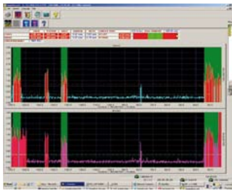
涡流检测机械裂纹二维图像
